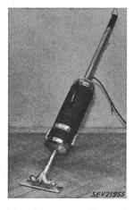
Aspirateur de poussière, selon figure. Soufflante centrifuge entraînée par moteur monophasé série, dont le fer est isolé des parties métalliques accessibles. Poignée isolée. Appareil utilisable avec tuyau souple, rallonges et diverses embouchures pour aspirer et souffler. Fiche d'appareil encastrée 6 A, 250 V, sans contact de terre. Cordon de raccordement à deux conducteurs isolés au caoutchouc, avec fiche et prise d'appareil munie d'un interrupteur.
