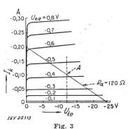
Kollektorcharakteristik und Arbeitskennlinie eines Leistungs-Transistors
