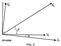
Vektorbild (Effektivwerte) der Spannungen  $V_n$  Netzspannung,  $V_s$  Drosselspulenspannung, Fourierkomponente mit Frequenz  $\omega$  der Lampenspannung  $v_{arc.}$  und des entsprechenden Lampenstromes  $I_1$
