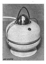
Humidificateur d'air («Air-Regenerator»), selon figure. Moteur monophasé, blindé, autodémarreur, à induit en court-circuit, avec disque projecteur et ventilateur pour la vaporisation de l'eau contenue dans un récipient. L'eau peut être additionnée d'un produit désinfectant ou autre. Carter en tôle de 185 mm de diamètre, dont la partie supérieure est maintenue par un étrier métallique partiellement isolé. Cordon de raccordement à double gaine isolante, fixé à l'appareil, avec fiche 2P+T.
