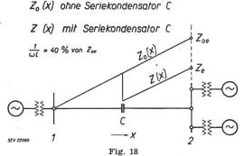
Herabsetzung der Leitungsimpedanz  $Z_e$  mit Hilfe von Serie-Kondensatoren
