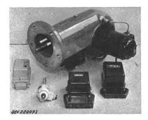
du mazout par pompe et gicleur. Allumage à haute tension. Entraînement par moteur triphasé, ventilé, à induit en courtcircuit. Commande par pyrostat à cellule photoélectrique, appareil automatique et thermostat de chaudière Landis & Gyr. Disjoncteur de protection de moteur Sprecher & Schuh, Régulateur de tirage Landis & Gyr.
