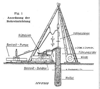
wänden für Wasserbauanlagen entwickelt. Es beruht auf der Verwendung von thixotropen Suspensionen, welche dadurch gekennzeichnet sind, dass sie im Ruhezustand schnell gelieren und
