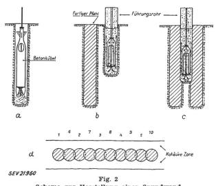
Schema zur Herstellung einer Spundwand a Ausbetonieren eines Pfahles; b Bohren mit Ausbauen des Zwischenpfahles; c Nachbohren des Zwischenpfahles; d Dichtungswand im Grundriss
