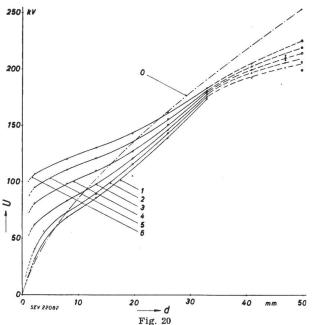
Wie Fig. 19, aber Darstellung der für bestimmte Verluste nötigen Versuchsspannungen U als Funktion des Seildurchmessers d
