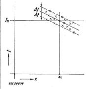
Fig. 5 Détermination de l'insensibilité du réglage en charge Valeur de la fréquence f en fonction de la valeur de la course du vannage x
