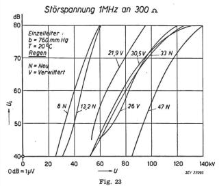
Radio-Störspannungen verschiedener Leiterseile unter Regen
