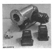
en court-circuit. Commande par pyrostat à cellule photoélectrique, appareil automatique et thermostat de chaudière Landis & Gyr. Régulateur de tirage Landis & Gyr.
