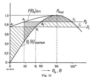
Dynamische Stabilität eines vorbelasteten Generators Po Vorbelastung; P dynamisch höchstzulässige Gesamtbelastung
