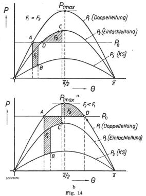
Dynamische Stabilität einer einfachen Übertragung beim Kurzschluss eines Stranges einer Doppelleitung a ohne Kurzschluss-Fortschaltung; b mit Kurzschluss-Fortschaltung
