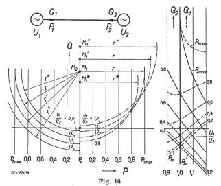
Einfluss des Spannungsabfalles auf einer 300 km langen, verlustlosen Übertragung auf den Blindlastbedarf an beiden Leitungsenden
