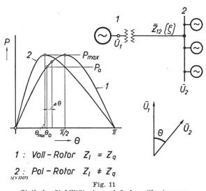
Statische Stabilität einer einfachen Übertragung 1 Leistungskurve eines Vollpol-Generators 2 Leistungskurve eines Generators mit ausgeprägten Polen
