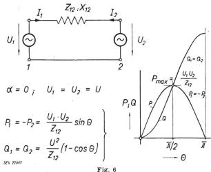
Darstellung der übertragenen Leistung einer verlustlosen, kurzen Leitung  $Z_{12}$  mit  $U_1 = U_2 = U$
