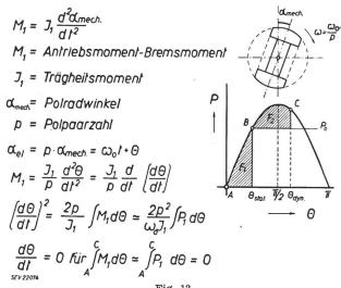
Dynamische Stabilität einer einfachen Übertragung Ableitung des «Flächenkriteriums»
