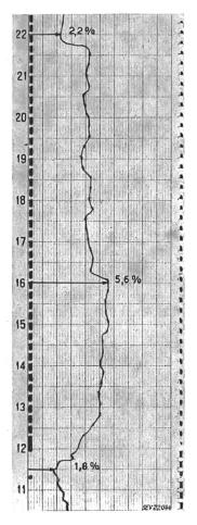
$Signal spannung sver \bar{l} auf \ im \ 380/220\text{-}V\text{-}Netz$ Entfernung vom Sender: 4,8 km (6-kV-Kabel) + 0,3 km (380/220-V-Kabel)
