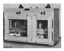
pour l'enclenchement et le déclenchement individuels des lampes et boîte de connexion, disposés sur l'étuve. Cordon renforcé à trois conducteurs, fixé à l'appareil, avec fiche  $2\ P+T$ .
