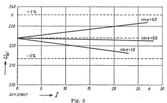
Kennlinien für die Spannungseinstellung eines kompensierten 6,25-kVA-Dauermagnet-Generators
