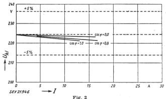
Kennlinien für die Spannungseinstellung eines kompensierten 6,25-kVA-Dauermagnet-Generators
