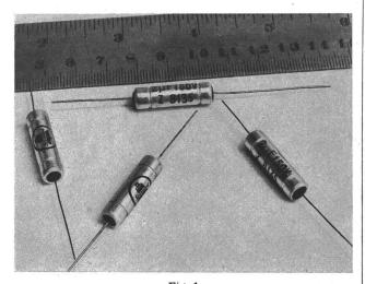
Fig. 1 Polarisierte Tantal-Elektrolyt-Kondensatoren 2 μF, 150 V
