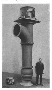
Fig. 1 Sulzer-Kühlwasserpumpe für ein thermisches Kraftwerk in Irland Einstufige vertikale Ausführung, Q=916 l/s, h=13,2 m, n=725 U./min
