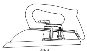
Darstellung des Schaltmechanismus des neuen Reglerbügeleisens
