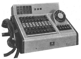
Fig. 2 Vermittlungsstation mit Blocktasten
