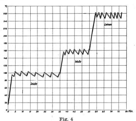
Temperaturkurve in Abhängigkeit von verschiedenen Stoffarten Gültig für alle Spannungen von 110...250 V
