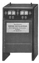
Ein Schaltschrank als Anschluss-Mess- und Verelektrische teilfeld für anf Energie Baustellen wird ebenfalls aufgestellt. Dieser enthält zwei Drehstrom - Vierleiteranschlüsse, die plombierbar und je mit einem Hauptschütz abschaltbar sind. Für jeden Hauptanschluss ist ein Zählertableau eingebaut. Weil meistens nur ein Hauptanschluss benötigt wird, besteht die Möglichkeit, beide
