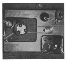
Fig. 1 Prüfung der mechanischen Walkfestigkeit von Schmierfetten mit dem 3-Kugelgerät
