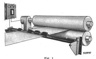
Dickenmess- und Regulieranlage für PVC-Folienwalzwerk Messköpfe mit radioaktiven Präparaten
