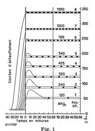
Courbes de température d'un four de 42 dm³, 2000 W sur les différentes positions de la manette
