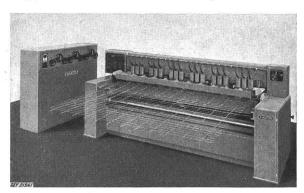
Fig. 2 Vollautomatische elektrische Schweissmaschine zur Fabrikation von Baustahlgeweben für Netzbreiten bis 2,65 m und Drahtstärken von 2,5 bis 12 mm  $\phi$
