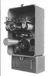
Anlagen mittlerer Grösse von 2...15 1/h. Für Brenner mit einem Verbrauch von mehr als 15 1/h ist die Normalautomatik mit Schaltelementen für grössere Schaltleistung verwendbar. Die photoelektrischen Flammenwächter dieser Automatik, die entweder mit Selenzelle und Magnetverstärker oder mit Vakuum- bzw. gasgefüllter Photozelle und Röhrenverstärker arbeiten, weisen eine sehr kurze Ansprechzeit auf. Das Ansprechen erfolgt — zur Überbrückung von kurz-
