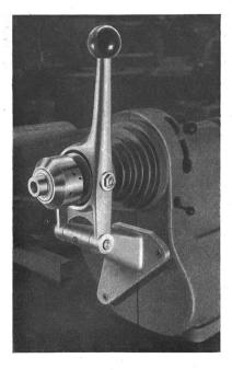
Fig. 3 Schnellspannvorrichtung
