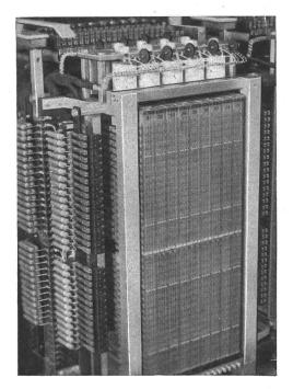
Fig. 1 Kreuzwähler zu Leitungsdurchschalter
