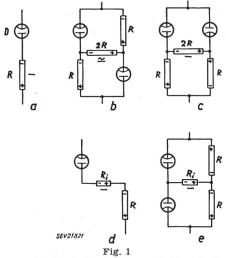
Asymmetrische Serieschaltung und Kombinationen a Einweg-(Strom-)Messung, hocholmig; b einphasige Spannungsverdopplung, symmetrisch (Spannungsmessung); c Zweiweg-Spannungsverdopplung (Spannungsmessung); d Einweg-(Strom-)Messung, niederohmig; e Zweiweg-Stromverdopplung, symmetrisch (Strommessung); D Diode; RArbeitswiderstand oder dessen Äquivalent; Ri Innenwiderstand des Strommessers
