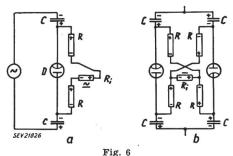
Symmetrische Parallelschaltung und Kombination a Einweg-Messung mit zwei Ladekondensatoren: Stromverdopplung, niederohmig Bezeichnungen siehe Fig. 1 und 3
