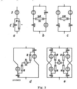
Asymmetrische Serieschaltung und Kombinationen a Einweg-Messung, hochohmig; b Einweg-Spannungsverdopplung, symmetrisch; c Zweiweg-Spannungsverdopplung; d Einweg-Spannungsverdopplung, niederohmig, symmetrisch; e Zweiweg-Spannungs- und Stromverdopplung, symmetrisch; C Ladekondensator
