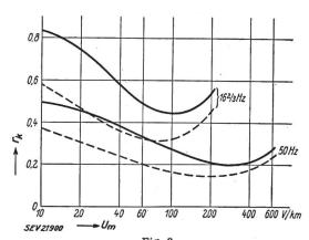
Fig. 2 Reduktionsfaktor rein Abhängigkeit von der induzierten Mantelspannung  $U_n$ Normal-Bandstahl
