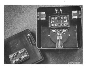
Fig. 13 Symmetrisches Zweiweg-Voltmeter mit 4 Kristallgleichrichtern Innenansicht
