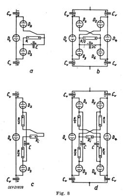
Symmetrische Parallel-Serie-Schaltungen mit ZweiwegSpannungsverdopplung und zwei Vorladekondensatoren C v
