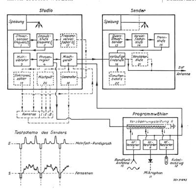
Für die zyklische Abfrage der Tonamplituden an den Klemmen der Programmleitungen beim Sender bedient man sich der in der Multiplex-Nachrichtenübertragung bewährten Mittel (Laufzeitketten, Elektronenschalter). Es ist nicht nötig, hier auf diese Frage näher einzutreten.
