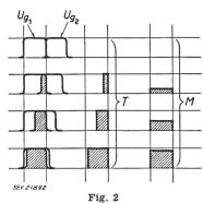
Überlappungsdauer der Gitterspannungen der Selektionsröhre  $U_{g_1}$  Öffnungsspannung am Gitter 1;  $U_{g_2}$  Öffnungsspannung am Gitter 2; T Dauer des Stromflusses im Anodenkreis; M Mittelwerte
