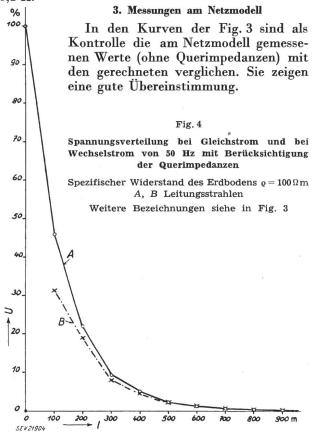
Die Kurven der Fig. 4 zeigen die gemessene Spannungsverteilung bei Berücksichtigung der Querimpedanzen im «Normalboden» ( $\varrho=100~\Omega m$ ). Es
