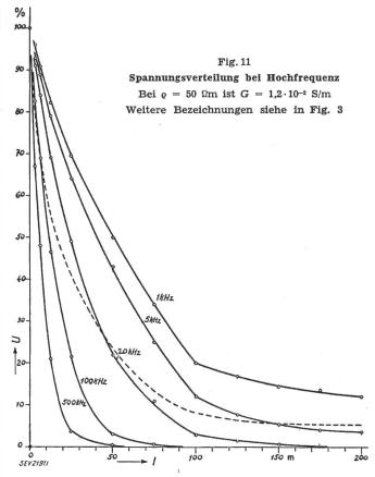
Ist demnach aus dem Frequenzspektrum bekannt, welches Frequenzintervall Gültigkeit besitzt, lässt sich der zu erwartende Spannungsabfall der Stoßspannung konstruieren. Wenn auch damit nicht eine ganz genaue Kurvenform erhalten wird, kann doch eine qualitative Aussage über den Verlauf bis zum ersten Knotenpunkt gemacht werden. Darüber hinaus wird die Berechnung kompliziert, die Messung jedoch immer noch sehr einfach.
