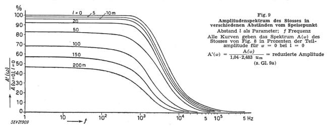
scheidet sie sich darin, dass die Front nicht mit horizontaler Tangente im Nullpunkt beginnt. Die Funktion  $f(t) \equiv U(t) = k (e^{-\alpha t} - e^{-\beta t})$  wird, als Fourierintegral dargestellt und mit den Beziehungen
