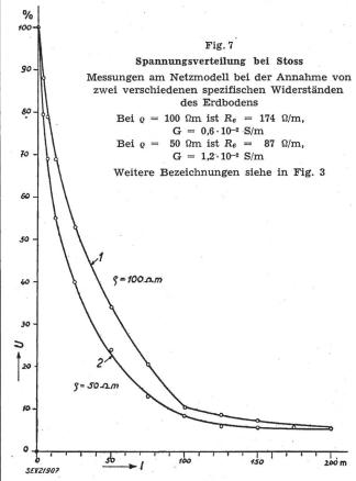
Der Vergleich mit den Kurven bei 50-Hz-Strömen zeigt, dass der räumliche Spannungsabfall bedeutend grösser ist. Dabei muss man sich bewusst sein, dass der Anfangswert der im Leitungsnetz auftretenden Stoßspannung (z. B. bei Blitzeinschlag) viel grösser sein kann als bei Spannungen von 50 Hz.
