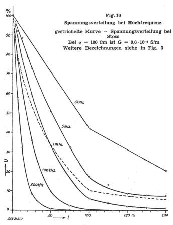
wegs keine Verzweigungen vorkommen, bis zum ersten Knotenpunkt mit der«oberen Grenzfrequenz»  $f_{+1}$  dargestellt werden kann (Tabelle I). Als «obere Grenzfrequenz» soll jene Frequenz berechnet werden, wo das Amplitudenspektrum auf ca. 1...1,5 % von  $A(\omega = 0)$  abgesunken ist.
