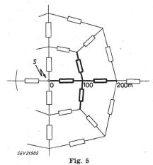
Netzausschnitt zur Untersuchung bei Stoßspannung Einschränkung der Untersuchung auf den fett ausgezogenen Teil S Speisepunkt
