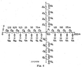
Netzmodell zur Untersuchung mit Stoßspannung S Speisepunkt; K<sub>1</sub> 1. Knotenpunkt
