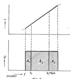
Fig. 7 Darstellung der Aufteilung der Fläche  $A_{total}$  durch das Zweikanal-Meßsystem
