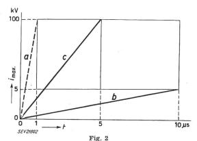
Diagramm der beim Erdblitz vorkommenden Steilheiten der Front  $T_F$
