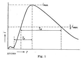
Prinzipielles Stromoszillogramm eines Erdblitzes  $T_F$  Frontdauer, 1...10  $\mu$ s;  $T_H$  Halbwertdauer, 10...100  $\mu$ s; i Strom des Erdblitzes, sein Maximum  $i_{max}$  beträgt 5...100 kA; t Zeit
