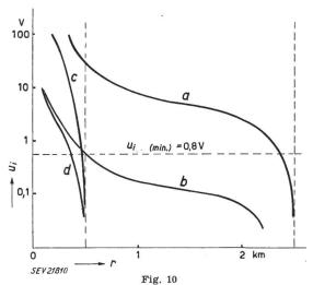
Vom Erdblitz in der Rahmenantenne induzierte Spannung  $u_i$  in Funktion des Abstandes r
