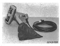
conducteurs isolés au caoutchouc, avec fiche 2 P pour 10 A, 50 V, introduit par un tube en caoutchouc et fixé à l'appareil. Le raccordement au réseau du moteur bobiné pour 24 V s'opère par un transformateur de protection pour locaux mouillés.
