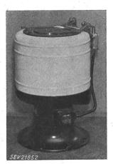
Essoreuse, selon figure, avec couvercle. Tambour en tôle de cuivre nickelée de 430 mm de diamètre et 300 mm de profondeur. Entraînement par moteur triphasé ventilé, à induit en court-circuit, logé dans le socle en fonte grise. Interrupteur bipolaire, actionné par l'ouverture et la fermeture du couvercle. Poignée isolée. Machine prévue pour raccordement fixe des amenées de courant.
