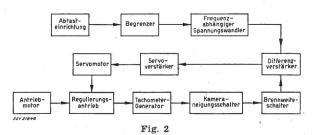
Blockschema der Synchronisierungseinrichtung
