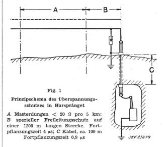
Aus praktischen Gründen mussten die Überspannungsableiter für die Fernleitungen in der Freiluftanlage neben den Kabelendverschlüssen aufgestellt werden und nicht nach den Kabeln in der Transformatorenstation. Diese Anordnung be-
