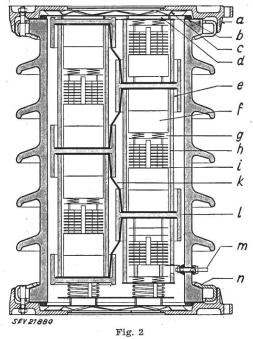
Längsschnitt durch den unteren Teil eines Überspannungs-ableiters XRSC
