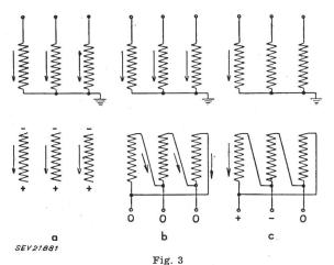
Magnetisch übertragene Spannungsstösse in einem Stern-Dreieck-Transformator
