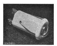
nelle. Trois ressorts en acier, disposés radialement, servent à la fixation de la lampe dans une plaque frontale (diamètre de perçage 21 mm). Raccordement par vissage ou soudage. Pour des tensions de 380 ou 500 V, une résistance supplémentaire de 68 et 120 k $\Omega$ , respectivement, est nécessaire.
