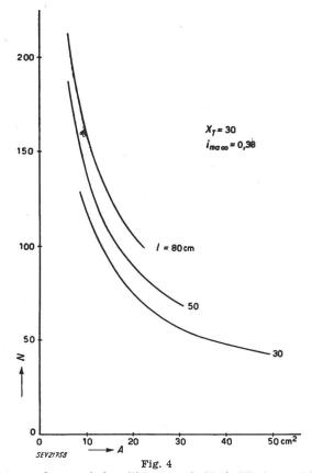
Zusammenhang zwischen Eisenquerschnitt A, Windungszahl N und mittlerer Kraftlinienlänge l eines berechneten Wandlers Grenzwert der Reaktanz des Wandlers maximaler Momentanwert des Magnetisierungsstromes
