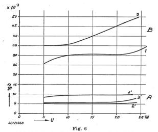
Dielektrische Verlustmessungen an 10-kV-Kabeln,  $3 \times 25~{
