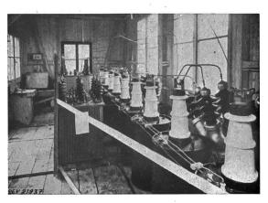
Fig. 5 Prüfeinrichtungen für die Dauerversuche
