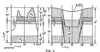
Diagramm der Lastenverteilung im Verbundbetrieb mit Windkraftwerken
