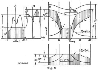
Betriebsweise der regelbaren Wasserkraftwerke
