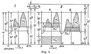
Zusammenwirken der Wind- und der Wasserkraftwerke I Leistungsbilanz ohne Windkraftwerke (bei niedrigem Was-
