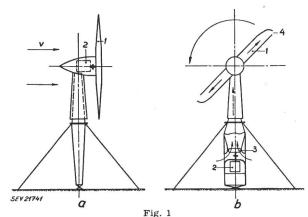
Bauformen von Windkraftwerken
