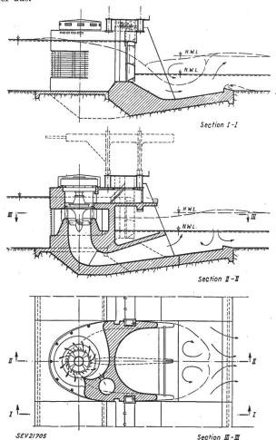
Fig. 1 Schnitt durch die Spirale und durch die Maschinengruppe
