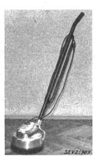
Cireuse, selon figure, avec une brosse plate entraînée par un moteur monophasé série, ventilé. Carcasse en métal léger, manche en tube d'acier, poignée recouverte de caoutchouc. Le fer du moteur et le manche sont isolés de la carcasse. Prise d'appareil, condensateurs et lampe à incandescence adossés au moteur. Cordon de raccordement à deux conducteurs, avec fiche, prise d'appareil et interrupteur de cordon.
