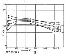
Fig. 1 Vergleich von Kathodenschmelze «D» und «66»
