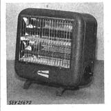
Radiateur, selon figure. Boudins chauffants enroulés sur deux barres en matière céramique. Réflecteurs en tôle de métal léger derrière chacun des corps de chauffe. Bâti en tôle. Poignée en fer rond, recouvert d'une gaine en matière thermoplastique. Commutateur rotatif pour trois allures de chauffe. Fiche d'appareil encastrée pour le raccordement de l'amenée de courant.
