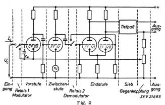
Prinzipschema des Zerhackerverstärkers Zur Modulation und Demodulation dienen zwei Telegraphenrelais  $I_0$  Strombelastung des Messobjekts;  $U_0$  Eingangsspannung;  $C_e$  Eingangskapazität der CF 50
