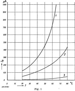
Temperaturcharakteristik von Elektrolytkondensatoren
