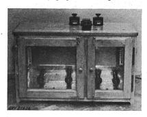
des deux compartiments par thermostats ajustables. Interrupteurs pour l'enclenchement et le déclenchement de deux lampes à la fois, boîte de jonction et thermostats disposés au dessus de l'étuve. Cordon de raccordement renforcé à trois conducteurs, fixé à l'étuve.
