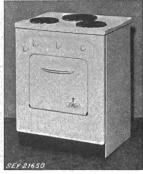
Cuisinière électrique, selon figure, avec trois foyers de cuisson et un four. Taque fixe. Plaques de cuisson de 180 mm (deux plaques) et 220 mm de diamètre, à bord d'acier inoxydable, montées à demeure. Corps de chauffe de voûte et de sole disposés à l'extérieur du four et réglés ensemble par un thermostat. Bornes prévues pour différents couplages. Poignées en matière isolante.
