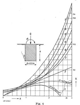
Reaktionsmomente für ein Blockfundament in Funktion der Tiefe nach verschiedenen Berechnungsmethoden Methode Mohr;
