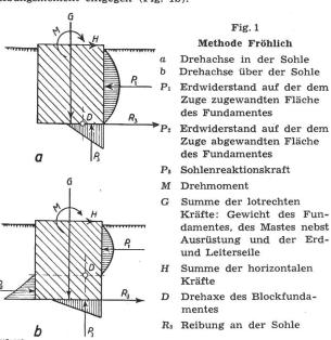
Dabei werden die seitlichen Erdwiderstände nach der klassischen Coulombschen Erddrucktheorie durch Kombination des aktiven und passiven Erddrucks bestimmt.
