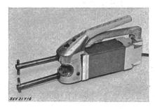
avec les poignées isolées. Des porte-électrode de diverses longueurs peuvent être montés. Contact unipolaire à poussoir dans le circuit primaire. Cordon de raccordement renforcé, à trois conducteurs, fixé à l'appareil.
