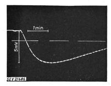
Fig. 3 Spannungsverlauf beim Kippen einer Zinksulfatlösung in einem Glasrohr
