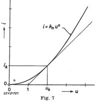
Die allgemeine parabolische Gleichrichtercharakteristik in relativer Darstellung mit  $U_n$  als Bezugsspannung u Gleichrichterspannung; i Gleichrichterstrom;  $u_k$  Spannung und  $i_k$  Strom für den Berührungspunkt der Parabel mit der Geraden von Fig. 6b; n Grad der Parabel;  $k_n$  Konstante der  $n^{\text{ten}}$  Parabel
