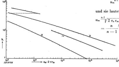
Mit einer Dreieckimpuls-Fehlerkurve ist daher für alle Messinstrumentwerte und Impulsdauern der Fehler in Funktion des Meßspannungswertes  $u_m$  direkt bestimmbar. Für die quadratische Parabel der Kontaktgleichrichter vereinfacht sich die Formel zu
