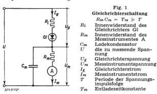
Fig. 1 zeigt die prinzipielle Meßschaltung für Einweggleichrichtung. Die Berechnungen gelten analog für beliebige Mehrphasen-Gleichrichterschaltungen. Es bedeutet: Gl Gleichrichter mit dem Innenwiderstand  $R_i$ ; A Messinstrument mit dem Innenwiderstand  $R_m$ ;  $C_m$  Ladekondensator. U ist die zu messende Spannung;  $U_g$ ,  $I_g$  sind Gleichrichter-Spannung und -Strom;  $U_m$ ,  $I_m$  Messinstrument-Spannung und -Strom.
