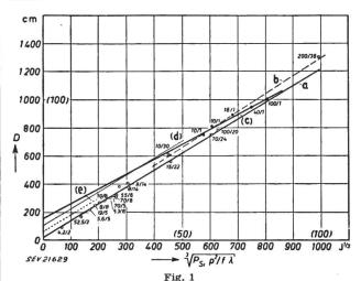
Durchmesser D moderner Synchrongeneratoren in Funktion von  $\sqrt[3]{P_{si} p^2/f \lambda}$
