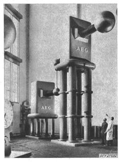
Fig. 1 Prüftransformator im Höchstspannungsfeld
