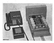
des circuits à fort et à faible courant. Le transformateur de réseau est protégé par de petits fusibles. Raccordement au réseau par cordon à trois conducteurs isolés au caoutchouc, avec fiche  $2\,P+T$ . Les diverses parties de l'appareil sont reliées entre elles par des cordons ronds.
