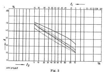
Dämpfungsverteilung auf Grund von über 1000 Versuchsstunden
