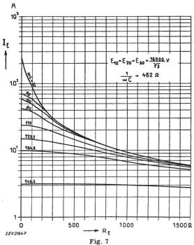
Erdschlußstrom  $I_E$  in Funktion des Ohmschen Widerstandes an der Erdschlußstelle  $R_E$
