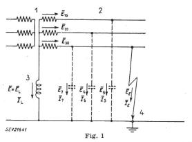
Direkter Erdschluss über einem Ohmschen Widerstand in einem Drehstrom-Hochspannungsnetz mit Löschspule 1 Haupttransformator im Unterwerk; 2 16-kV-Netz; 3 Löschspule; 4 Erdschlußstelle: Weitere Bezeichnungen siehe im Text
