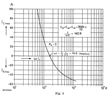
Maximalwert des Erdschlußstromes  $I_{E\,max}$  in Funktion des induktiven Widerstandes  $\omega L$  der Löschspule
