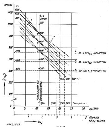
Fig. 2 Wettbewerbsfähige Ausbaukosten des Pumpspeicherwerkes in Abhängigkeit vom Preis der benötigten Schwachlastenenergie Die Geraden scheinen um die Punkte p zu drehen; dies rührt daher, dass für  $b_N=0.22$  kg/kWh das Produkt  $\Delta b \cdot T$  ungefähr konstant bleibt
