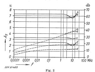
Elektrische und magnetische Schirmdämpfung  $A_s$  (in Neper od. in Dezibel) von einfachen Maschendrahtwänden f Frequenz
