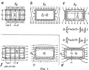
Abschirmung elektrischer und magnetischer Felder durch Gehäuse aus Maschendraht, Metallfolie oder aus Stoffen mit hoher Dielektrizitätskonstante  $\epsilon_r$  oder grosser Permeabilität  $\mu_r$
