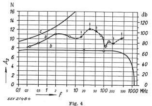
Dämpfungskurven des Labora oriums mit 4 Fenstern und 80 m² Grundfläche. Störquelle: 200-kW-Sender, 150 kHz...100 MHz
