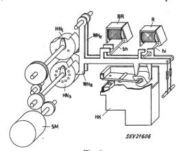
Fig. 6 Prinzipdarstellung des Wählers
