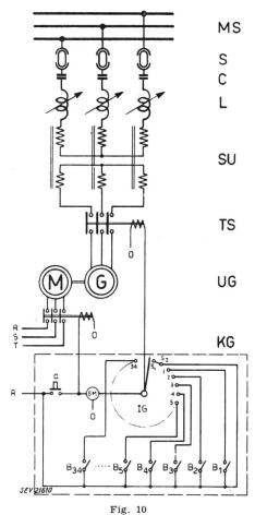
Prinzipschema einer Sendeanlage (System Ghielmetti)
