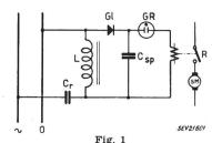
Eingangsschaltung mit Impulsverstärkung durch Speicherung
