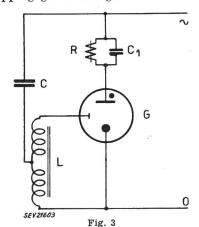
Eingangsschaltung des Ghielmetti-Empfängers Impulsverstärkung durch Kaltkathoden-Gastriode
