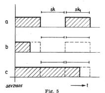
Kontrolle des Start- und Sicherheitsimpulses Schliesszeit von Kontakt sk bzw. sk1
