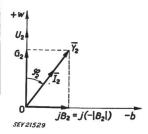
im negativen Sinn gegen den Spannungszeiger  $U_2$  gedreht. Der Phasenwinkel  $\varphi_2 = \langle (U_2, \bar{I}_2) \rangle$  am Leitungsende 2 hat dann einen negativen Wert
