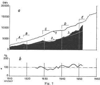
a Développement de la production hydro-électrique suisse et de l'utilisation de l'énergie dans le pays
