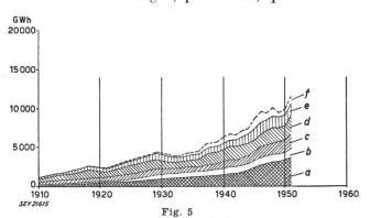
Consommation suisse d'énergie brute en GWh électricité (prise à l'usine) a usages domestiques et artisanat; b traction; c industrie générale; d chimie et métallurgie; e pertes et énergie de pompage; f chaudières électriques
