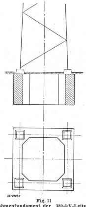
Rahmenfundament der 380-kV-Leitung Amsteg—Mettlen
