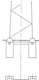
Beim Bau der 380-kV-Leitung Amsteg-Mettlen wurden die Maste mit tiefen Einzelfundamenten ver-
