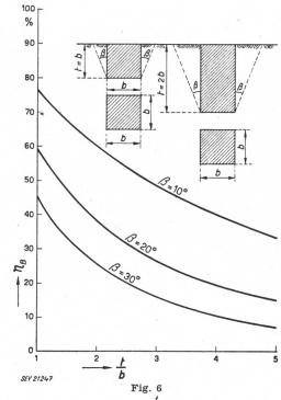
Einfluss des Verhältnisses  $\frac{t}{b}$  auf das Betongewicht  $\eta_B$  Anteil des Fundamentbetons am Gesamtgewicht von Beton plus Erdmasse in Keilform; t Tiefenmass; b Breitenmass des Fundamentes;  $\beta$  Winkel des Erdkeils
