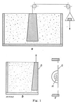
Zapfenfundament-Modellversuch in Holzkiste (1922) a Längsschnitt; b Querschnitt; c Draufsicht G Glasplatte; H Zapfen aus Holz
