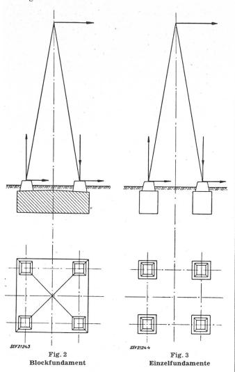
Mit der entwickelten Berechnungsmethode und den so angegebenen Baugrundziffern wurden in der Folge die weiteren Blockfundamente in der Schweiz berechnet.
