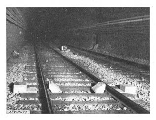
Fig. 7 Impulsgeber für die Achszählung im Gotthardtunnel
