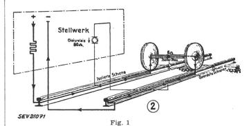
Prinzipschema der isolierten Schiene
