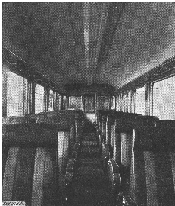
Fig. 2 Personenabteil an einer Stirnseite mit 20 drehbaren Doppelstühlen
