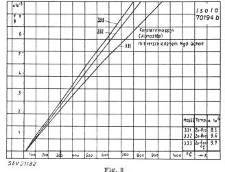
Verlauf der linearen Ausdehnung verschiedener keramischer Massen
