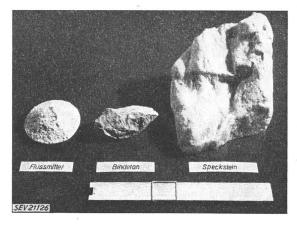
Fig. 2 Anteil von Speckstein, Bindeton und Flussmittel
