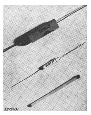
Fig. 7 Vergleich eines Papierkondensators mit einem keramischen Kondensator
