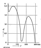
Eine genügende Erhöhung der Übersprechdämpfung wird erzielt, indem man die letzte Strecke der zum Unterwerk führenden Leitung verkabelt. Die Betriebsdämpfung zwischen einem Hochspannungsleiter vor seiner Einführung in
