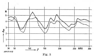
Betriebsdämpfung eines Starkstromtransformators 60/20 kV, 6000 kVA
