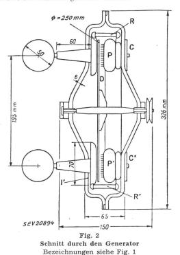
In Fig. 2 ist ein entsprechend dem Schema 1A gebauter elektrostatischer Generator im Schnitt dargestellt. Die im Gehäuse enthaltene Luft wird durch ein Trockenmittel von allem Wasser befreit. Bei einer Drehzahl von 4000 U./min und einer Spannung von 100 kV gibt diese Maschine eine
