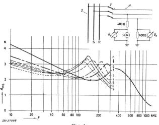
Fig. 1 Betriebsdämpfung zwischen zwei Sammelschienenleitern eines Drehstromsystems
