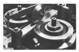
Fig. 1 Aufbiegen des Aluminiumbandes
