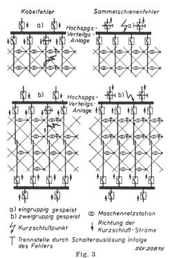
Abschaltung von Hochspannungsfehlern bei ein- und mehrgruppig gespeisten Netzen
