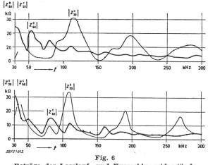
Beträge der Leerlauf- und Kurzschlusswiderstände eines Starkstromtransformators 60/20 kV
