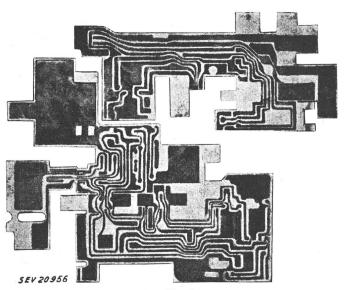
Fig. 1 Gefaltete gedruckte Schaltung für einen Miniatur-Radioempfänger
