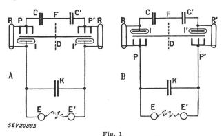
Schaltungen von elektrostatischen Influenzmaschinen
