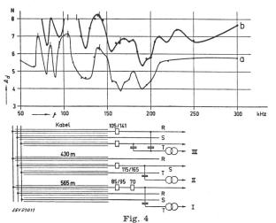
Einfluss von Hochspannungskabeln auf die Übersprechdämpfung von Schaltstationen f Frequenz; Ad Übersprechdämpfung Messung: a Dämpfung I-III; b Dämpfung II-III
