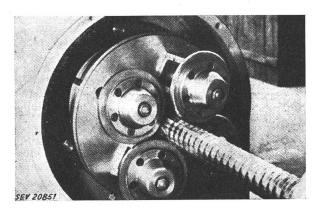
Fig. 2 Rillen der Armierung Die Ganghöhe ist einstellbar
