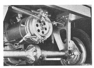
Fig. 6 Hinterachse mit Motor und Bremsen
