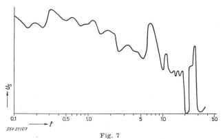
Qualitativer Verlauf der Störspannung am Ausgang eines Radioempfängers, hervorgerufen durch eine Leuchtstofflampe, in Funktion der Eingangsspannung
