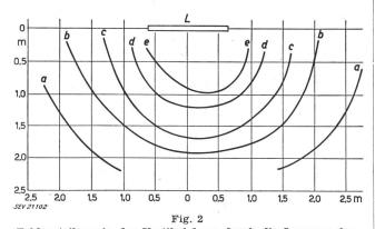
Feldverteilung in der Vertikalebene durch die Lampenachse mit den Kurven äquivalenter, vertikaler Feldstärke a 1,5 mV/m; b 2,3 mV/m; c 4,43 mV/m; d 5,6 mV/m; e 18,0 mV/m Alle Werte bei 550 kHz L Lampe
