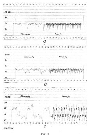
Störspannung am Ausgang eines Radioempfängers, hervorgerufen durch eine Leuchtstoffröhre
