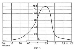
Feldstärkeverteilung in der Längsrichtung der Leuchtstoflampe (Maximaler Wert = 100 %) L Lampe
