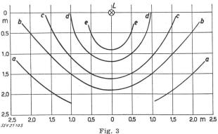
Feldverteilung in der Vertikalebene durch die Mittelsenkrechte der Röhre mit den Kurven äquivalenter, vertikaler Feldstärke Bezeichnungen siehe Fig. 2
