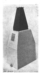
Eine noch neuere, ausserordentlich raumsparende Bauart eines kombinierten Strom- und Spannungswandlers 45 kV ist in Fig.15 wiedergegeben. Solche Wandler werden bereits bis 60 kV gebaut. Der Spannungswandler, Pol-Erde, befindet sich direkt unter dem Stromwandler im selben Kunstharzblock.
