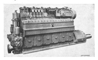
Fig. 3 6-Zylinder-2-Takt-Schiffsdieselmotor (Sulzer) Leistung 330 kW (450 PS),  $n=400\ U./min$
