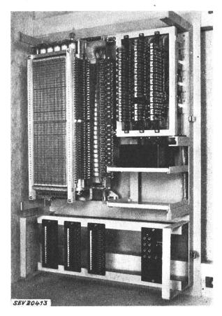
Fig. 8 Leitungsdurchschalter der Gfeller A.-G.
