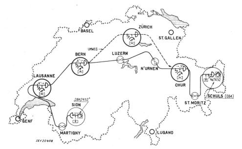
Fig. 3 Prinzip der automatischen Fernverbindung Sion-Schuls
