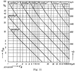
Courbes pour la détermination de la capacité du condensateur, apte à diminuer la tension psophométrique
