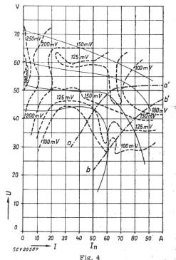
Variation de la tension psophométrique en fonction du courant et de la tension
