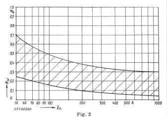
Facteur de forme téléphonique  $K_{\psi}$  à pleine charge, pour des machines téléphoniques des Ateliers de Construction Oerlikon (ACO)
