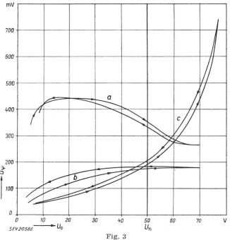
Variation de la tension psophométrique  $U_{\psi}$  en marche à vide, à environ 1500 t./min, en fonction de la tension aux bornes  $U_0$
