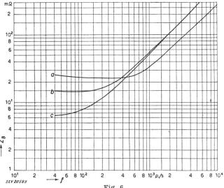
Fig. 6 Impédance de batteries d'accumulateurs au plomb (ZB) en service dans des centraux téléphoniques suisses à 60 V
