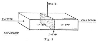
Aufbau eines Junction-Transistors vom n-p-n-Typus
