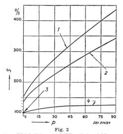
Belastungsfähigkeit innengekühlter Rotorwicklungen und selbstkühlender Wicklungen in Funktion des  $H_2$ -Druckes Stromdichte in %; p ( $H_2$ ) in pounds pro inch² ( $\times$  0,0703 kg/cm²) 1 innengekühlte Rotorwicklung bei forcierter Ven-
