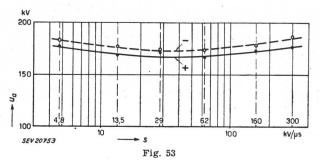
Tension d'amorçage u du parafoudre nº 12, fabrication C, en fonction de la raideur s de la tension de choc
