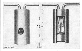
Fig. 1 Point-Contact-Transistor älterer Bauart
