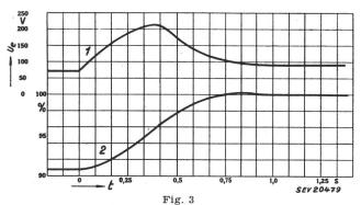
$\begin{tabular}{lll} Ansprechgeschwindigkeit \\ U & Erregerspannung; & Zeit \\ 1 & Erregerspannung; & 2 & Generatorspannung \\ \end{tabular}$
