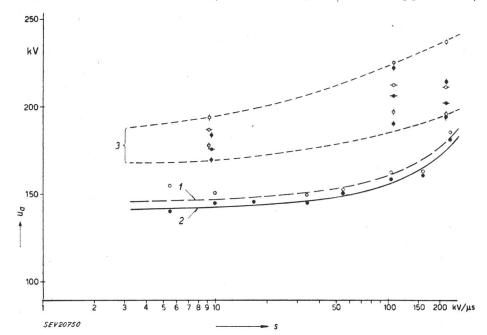
Tension d'amorçage de deux éclateurs à sphères, en fonction de la raideur de la tension de choc
