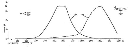
Fig. 26 Courbe de fréquence des tensions de contournement de la traversée représente sur la fig. 3 Désignations, comme pour la fig. 24
