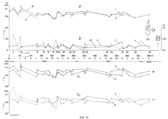
Tension d'amorçage de l'éclateur à sphères de 125 mm de dia nètre, à axe vertical, représenté sur la fig. 5, ramenée à la densité normale de l'air (760 mm Hg, 20 °C)
