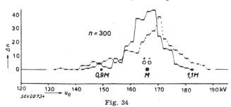
Courbe de fréquence des tensions d'amorçage du parafoudre nº 7, fabrication B Désignations, comme pour la fig. 31
