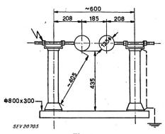
Fig. 5 Croquis côté de l'éclateur à sphères Diamètre des sphères 125 mm
