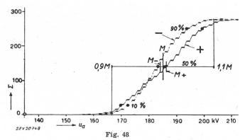
Fréquence cumulée des tensions d'amorçage du parafoudre n° 12, fabrication C, représentée en coordonnées linéaires Désignations, comme pour la fig. 43
