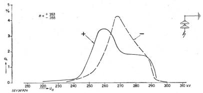
Fig. 24 Courbe de fréquence des tensions de contournement de l'isolateur de suspension représenté sur la fig. 1 n Nombre de mesures; u Tension de contournement; p Fréquence en %, par kV d'intervalle de tension
