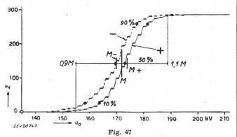
Fréquence cumulée des tensions d'amorçage du parafoudre n° 11, fabrication C, représentée en coordonnées linéaires Désignations, comme pour la fig. 43
