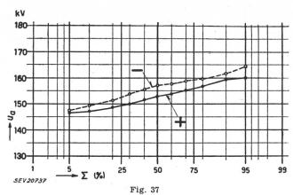
Fréquence cumulée des tensions d'amorçage du parafoudre n° 1, fabrication A, reportée sur un réseau de probabilité Fréquence cumulée en pour cent de l'amorçage à des tensions inférieures à la valeur d'ordonnée u Tensions d'amorçage
