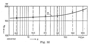
Tension d'amorçage u du parafoudre nº 7, fabrication B, en fonction de la raideur s de la tension de choc
