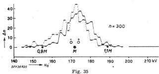
Courbe de fréquence des tensions d'amorçage du parafoudre n° 11, fabrication C
