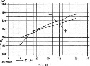
Fréquence cumulée des tensions d'amorçage du parafoudre n° 6, fabrication B, reportée sur un réseau de probabilité Désignations, comme pour la fig. 37
