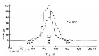
Courbe de fréquence des tensions d'amorçage du parafoudre nº 2, fabrication A
