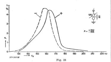
Courbe de fréquence des tensions d'amorçage de l'éclateur à sphères de 125 mm de diamètre (non nettoyées), à axe vertical, représenté sur la fig. 5
