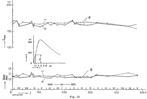
Tension d'amorçage mesurée du parafoudre n° 2, fabrication A, non ramenée à la densité normale de l'air Désignations, comme pour la fig. 18
