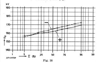
Fréquence cumulée des tensions d'amorçage du parafoudre n° 2, fabrication A, reportée sur un réseau de probabilité Désignations, comme pour la fig. 37
