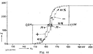
Fréquence cumulée des tensions d'amorçage du parafoudre nº 2, fabrication A, représentée en coordonnées linéaires Désignations, comme pour la fig. 43
