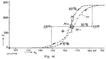
Fréquence cumulée des tensions d'amorçage du parafoudre n° 7, fabrication B, représentée en coordonnées linéaires Désignations, comme pour la fig. 43
