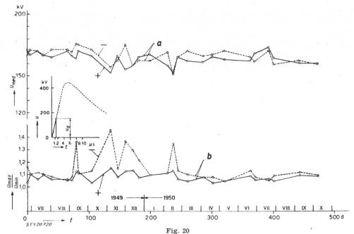
Tension d'amorçage mesurée du parafoudre nº 6, fabrication B, non ramenée à la densité normale de l'air Désignations, comme pour la fig. 18
