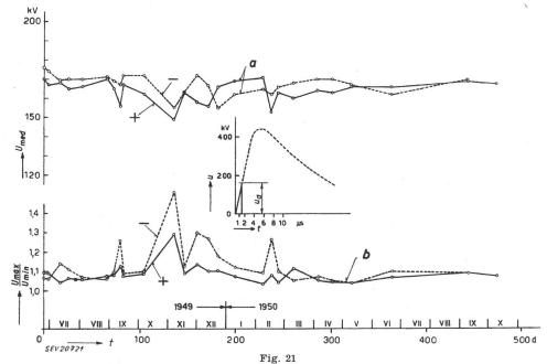
Tension d'amorçage mesurée du parafoudre nº 7, fabrication B, non ramenée à la densité normale de l'air Désignations, comme pour la fig. 18
