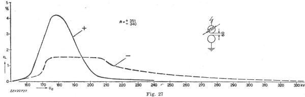
Courbe de fréquence des tensions d'amorçage de l'éclateur à sphères de 250 mm de diamètre, représenté sur la fig. 4 Désignations, comme pour la fig. 24
