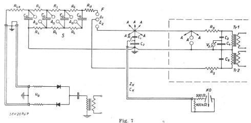
Schéma de l'installation de choc et de mesure
