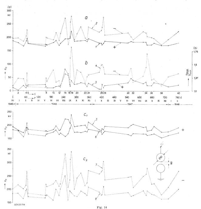
Tension d'amorçage de l'éclateur à sphères de 250 mm de diamètre représenté sur la fig. 4, ramenée à la densité normale de l'air (760 mm Hg, 20 °C)
