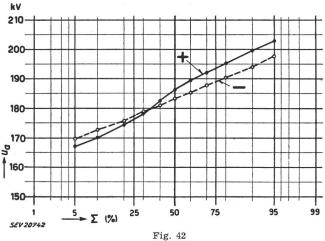
Fréquence cumulée des tensions d'amorçage du parafoudre n° 12, fabrication C, reportée sur un réseau de probabilité
