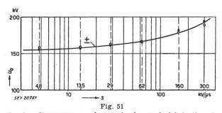
Tension d'amorçage u du parafoudre nº 2, fabrication A, en fonction de la raideur s de la tension de choc
