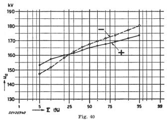
Fréquence cumulée des tensions d'amorçage du parafoudre n° 7, fabrication B, reportée sur un réseau de probabilité Désignations, comme pour la fig. 37
