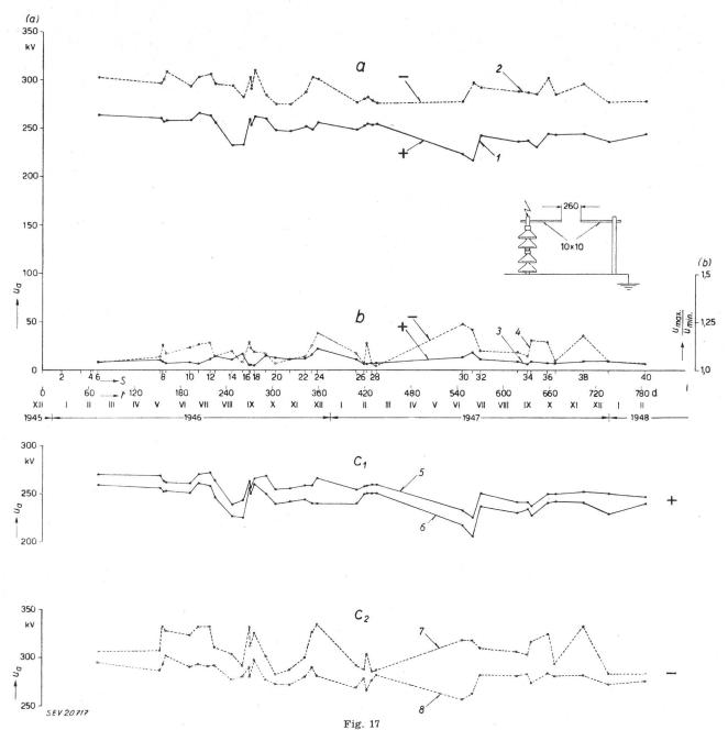
Tension d'amorçage de l'éclateur à tiges représenté sur la fig. 6, ramenée à la densité normale de l'air (760 mm Hg, 20 °C) a, b et c, comme pour la fig. 11
