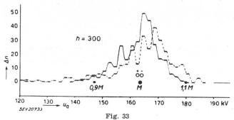
Courbe de fréquence des tensions d'amorçage du parafoudre nº 6, fabrication B
