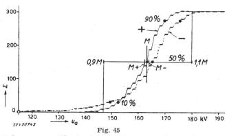
Fréquence cumulée des tensions d'amorçage du parafoudre n° 6, fabrication B, représentée en coordonnées linéaires Désignations, comme pour la fig. 43
