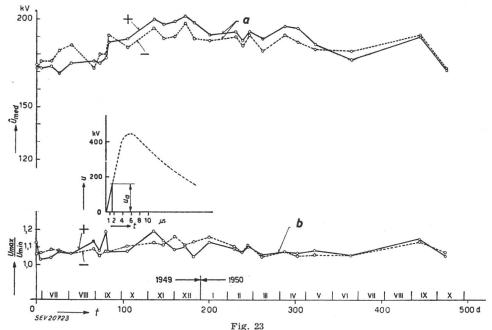
Tension d'amorçage mesurée du parafoudre nº 12, fabrication C, non ramenée à la densité normale de l'air Désignations, comme pour la fig. 18
