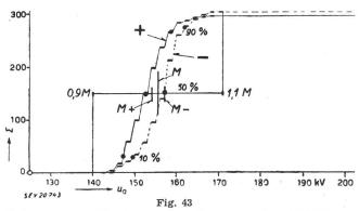
Fréquence cumulée des tensions d'amorçage du parafoudre nº 1, fabrication A, représentée en coordonnées linéaires
