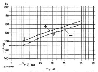
Fréquence cumulée des tensions d'amorçage du parafoudre n° 11, fabrication C, reportée sur un réseau de probabilité P Tension 50 % d'amorçage, pour chocs négatifs Q Tension 5 % d'amorçage, pour chocs positifs Autres désignations, comme pour fig. 37
