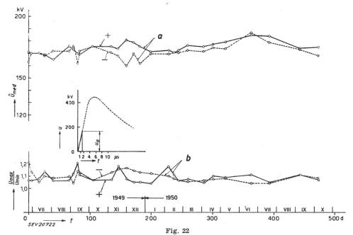
Tension d'amorçage mesurée du parafoudre nº 11, fabrication C, non ramenée à la densité normale de l'air Désignations, comme pour la fig. 18
