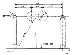
Fig. 4 Croquis côté de l'éclateur à sphères Diamètre des sphères 250 mm
