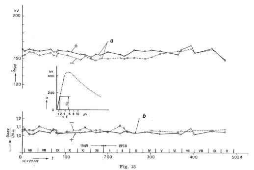
Tension d'amorçage mesurée du parafoudre nº 1, fabrication A, non ramenée à la densité normale de l'air a Moyennes positives et négatives de chaque série de mesures b Rapport maximum/minimum de chaque série de mesures
