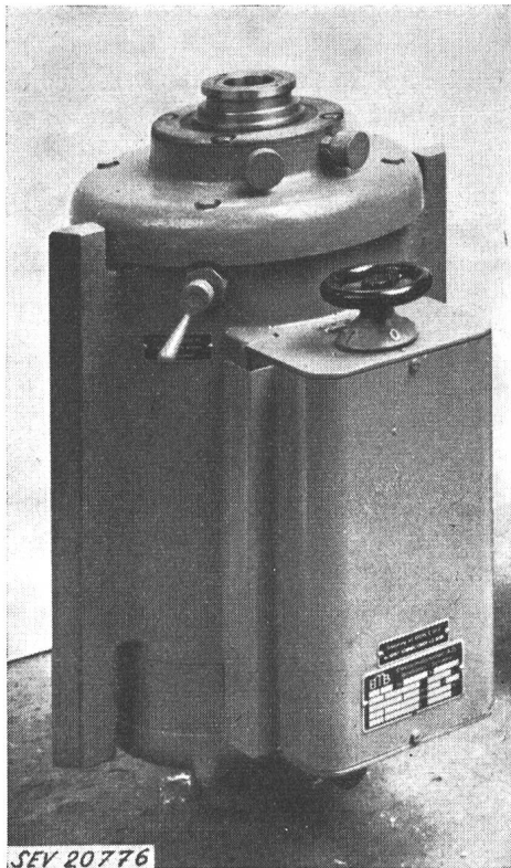
Fig. 1 Kehlmotor für Holzbearbeitung für 3000, 4500 und 6000 U./min, mit Links- und Rechtslauf
