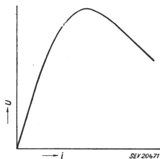
Fig. 8 Charakteristik eines Thermistors
