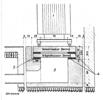
Fig. 3 Auflager der Transformatoren
