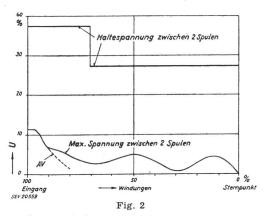
Beanspruchung zwischen den Spulen bei einem vollen StossU maximale Spannung zwischen Doppelspulen in % der Stoßspannung
