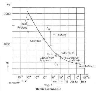
Scheitelwerte und Dauer der in einem 380-kV-Netz vorkommenden Spannungen
