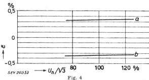
Übersetzungsfehler  $\epsilon$  in Funktion der Spannung  $U_n/\sqrt{3}$  bei einer sekundären Belastung von  $\alpha$ : 25 VA, b: 100 VA,  $\cos \varphi_2 = 0.8$
