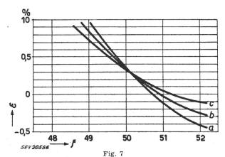
Übersetzungsfehler  $\epsilon$  in Funktion der Frequenz f für eine Primärspannung von a: 80 %, b: 100 %, c: 120 % der Nennspannung
