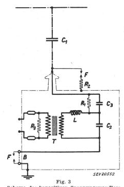
Schema des kapazitiven Spannungswandlers
