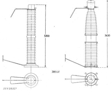
deren Durchmesser bei 380 kV unter dem Flansch 250 mm nicht überschreitet.
