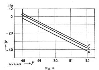
Fehlwinkel  $\psi$  in Funktion der Frequenz f für eine Primärmärspannung von a: 80%, b: 100%, c: 120% der Nennspannung
