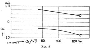
Fehlwinkel  $\psi$  in Funktion der Spannung  $U_n/\sqrt{3}$  bei einer sekundären Belastung von a: 25 VA, b: 100 VA,  $\cos \varphi_2 = 0.8$
