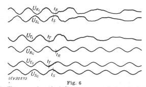
Oszillogramm der Abschaltung einer am Ende mit einem leerlaufenden Transformator belasteten Leitung bei 404 kV Bezeichnungen wie in Fig. 4
