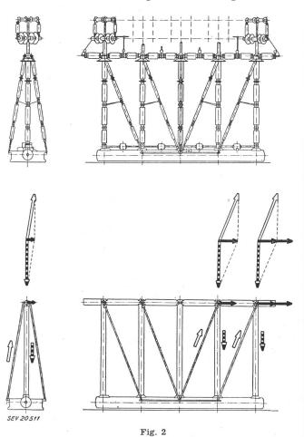
Schematische Darstellung der mechanischen Kräfte bei Beanspruchung eines 380-kV-Schalterpols durch Winddruck und Seilzug
