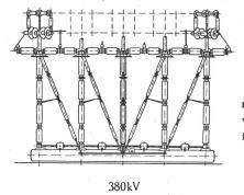
Fig. 1 Aufbau der Schalterreihe für Spannungen von 80 bis 380 kV aus identischen Elementen
