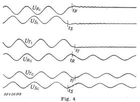
Oszillogramm der Abschaltung einer leerlaufenden Leitung von 476 km Länge bei 475 kV mit dem 380-kV-Schalter in der Anlage Harsprånget
