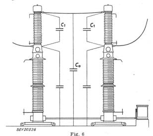
Schematische Darstellung eines Schalterpoles für 380 kV mit den für die Spannungsverteilung auf beide Unterbrechungsstellen massgebenden Kapazitäten
