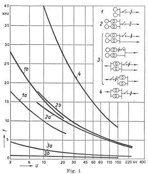
Fréquences propres (f) en fonction de la tension de service (U), calculées pour différentes configurations de réseaux
