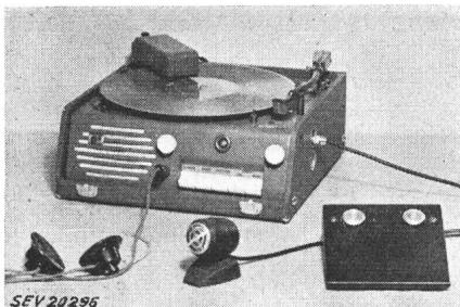
formateur de réseau à enroulements séparés. Tube redresseur. Un petit fusible dans le circuit primaire et un dans le circuit secondaire. Entraînement du plateau par moteur monophasé à induit en court-circuit. Tête d'enregistrement et de reproduction. Microphone à cristal, écouteur à serre-tête et interrupteur à pédale pour le freinage du tourne-disque. Cordon de raccordement à deux conducteurs torsadés, fixé à l'appareil, avec fiche 2 P.
