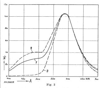
Relative spektrale Energieverteilung einer Weiss-Leuchtstoffröhre (mit Halogenleuchtstoff) Bezeichnungen siehe Fig. 1
