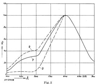
Relative spektrale Energieverteilung einer Weiss-Leuchtstoffröhre (mit zusammengesetztem Leuchtstoff) Bezeichnungen siehe Fig. 1
