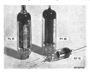
Fig. 12 Einige typische Fernseh-Empfängerröhren in Miniaturausführung
