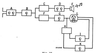
Fig. 10 Blockschema eines Fernseh-Empfängers
