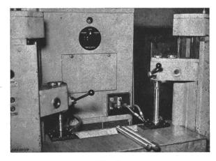
Fig. 17 Härtung von Frontachsen von Traktoren Arbeitsplätze
