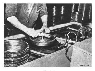
Fig. 19 Arbeitstisch für Aufschrumpfen und Härten des Zahnkranzes
