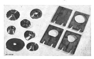
Fig. 9 Arbeitsspulen in Form von Kupferplatten; daneben behandelte Arbeitsstücke
