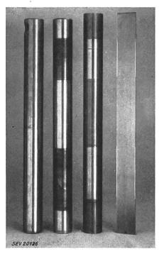
Fig. 16 Härtung von Frontachsen von Traktoren
