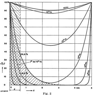
Stromverteilung in einem Cu-Leiter von 5 mm Durchmesser bei verschiedenen Frequenzen
