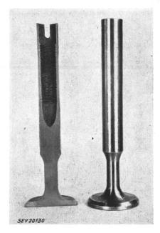
Fig. 20 Gehärtetes, mit flüssigem Natrium gekühltes Ventil
