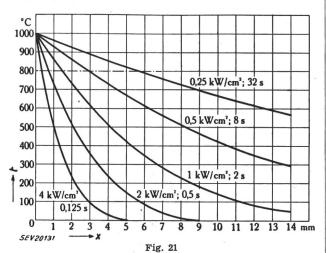
Verlauf der Temperatur t in Stahl in Funktion des Abstandes x von der Oberfläche
