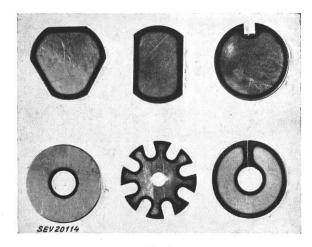
Fig. 4 Wirkung des Skin-Effektes an Querschnitten verschiedener Form Bei Anbringung eines Magnetfeldes im Innern ist eine Stromkonzentration an der Innenseite möglich (Querschnitt unten links)
