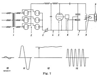
Prinzipschaltbild eines induktiven Hochfrequenzgenerators (darunter die den verschiedenen Stufen entsprechenden Spannungen)
