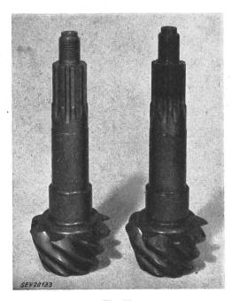
Fig. 23 Anlassen von Differentialgetrieberädern
