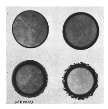
Fig. 3 Wirkung des Skin-Effektes an runden Querschnitten Die Querschnitte zeigen deutlich, wie der Strom an die Ober-fläche gedrängt wird, welche sogar zum Schmelzen gebracht werden kann (Querschnitt rechts unten)
