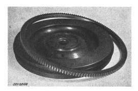
Fig. 18 Zahnkranz mit Schwungrad
