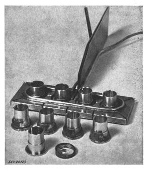
Fig. 13 Lötarbeit an Messinghülsen
