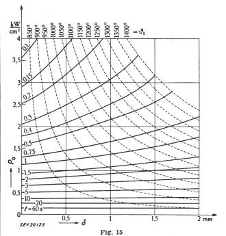
Härtetiefe  $\delta$  in Funktion der Oberflächenleistung  $P_0$   $\delta$  Härtetiefe in mm  $P_0 \quad \text{Oberflächenleistung in kW/cm}^2$ Parameter: t Zeit in s;  $\mathfrak{S}_0$  Temperatur in °C
