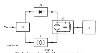
Blockschema eines Hochfrequenzgenerators S Steuerung; H Anodenspannungsgleichrichter; T Heiztransformator; O Oszillator; A Anpassungsgerät
