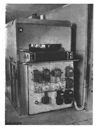
Fig. 24 Versuchsbackofen mit eingebautem 4-kW-HF-Generator
