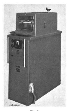
Fig. 9 4-kW-Hochfrequenzgenerator, 27 MHz, für dielektrische Erwärmung mit offenem Behandlungskondensator
