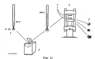
Prinzip der Preßstofferwärmung mit Hochfrequenz 1 Presslinge; 2 Hochfrequenz-Erwärmung; 3 Wärme; 4 Presse; 5 Fertigfabrikate
