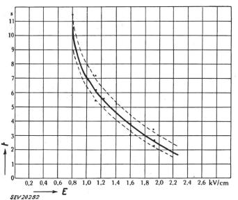
Fig. 22 Tötungszeit t von Mehlmotten in Abhängigkeit der Hochfrequenzfeldstärke E
