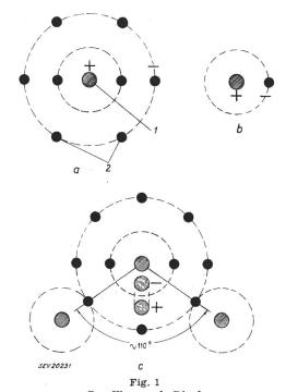
Das Wasser als Dipol a Sauerstoffatom 8016 (1 Atomkern, 2 Elektronen); b Wasserstoffatom 1H1; c Wassermolekül H2O
