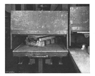
Fig. 16 Verleimung und Pressung von Radiogehäuse-Zierleisten mit Hochfrequenzerwärmung
