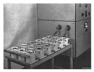
Fig. 21 Trocknung von Garnspulen mit Hochfrequenz
