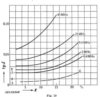
Dielektrische Eigenschaften des Holzes Verlustfaktor tg $\delta$  und Dielektrizitätskonstante  $\epsilon$  von Weymutsföhre in Abhängigkeit von der relativen Feuchtigkeit X.
