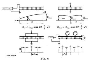
Spannungsverteilung bei ausgedehnten Arbeitskondensatoren λ Wellenlänge der verwendeten Frequenz a Abstand zwischen Spannungs-Minima und -Maxima
