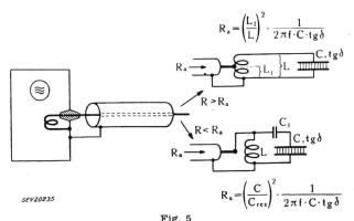
Anpassung der Belastung an Feederleitungen und Generatoren  $R_a$  Anpassungswiderstand; C,  $tg\delta$  durch das Behandlungsgut bestimmte Werte; L,  $L_1$ ,  $C_1$  Abstimmelemente
