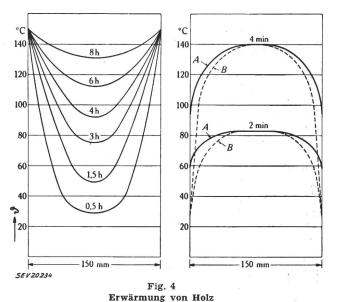
links: Temperaturverteilung bei Anwendung von Heizplatten von 150°C
