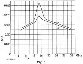
Verlustwinkel δ von Zucker in Funktion der Frequenz f
