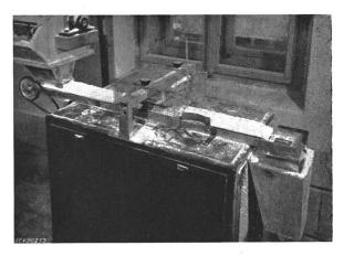
Fig. 23 Versuchsanlage zur Mehlsterilisierung mit Hochfrequenz-Energie im Durchlaufverfahren
