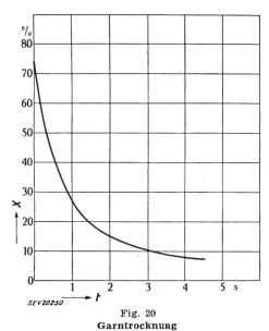
Relative Feuchtigkeit X in Funktion der Zeit t bei Garntrocknung im Hochfrequenzfeld
