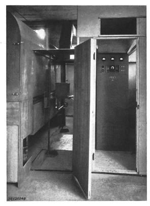
Fig. 18 Herstellung von fournierten Kunstholztüren nach dem Curvi-Board-Verfahren in der Presse mit einem 25-kW-Hochfrequenzgenerator zur Heissverleimung
