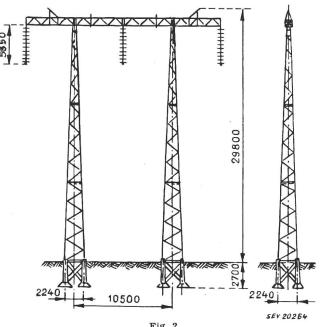
Fig. 2 Stützpunkt der 400-kV-Leitung
