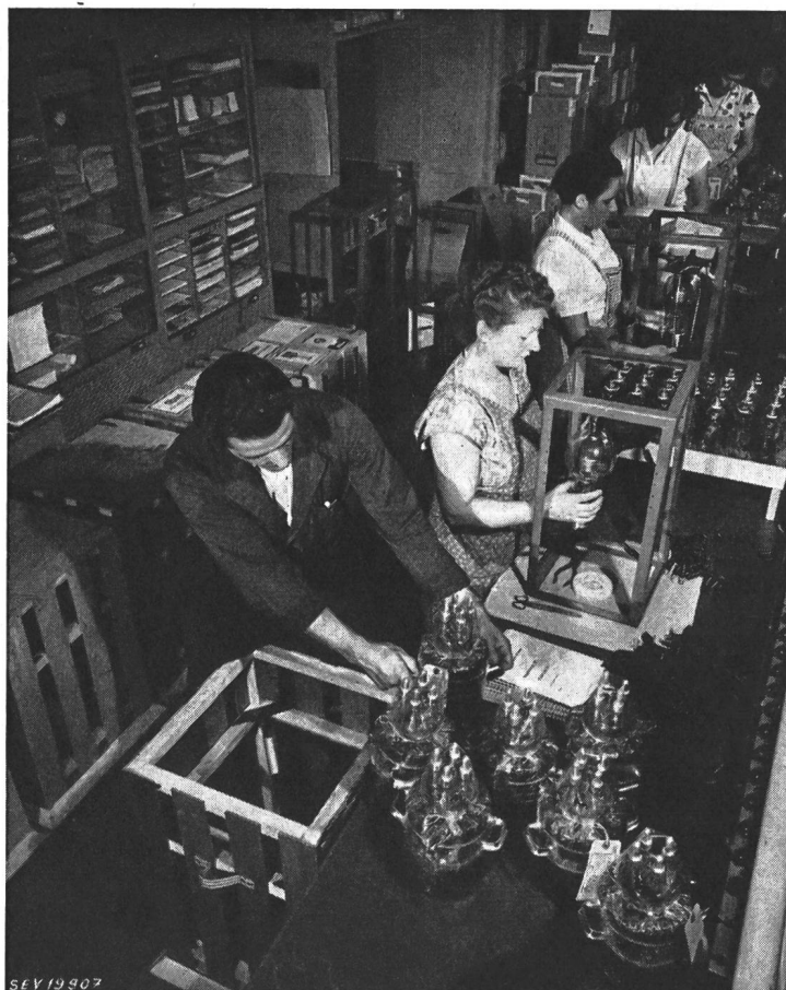
Fig. 6 Verpacken von Senderöhren Vor dem Versand werden die Röhren in mit Federn versehenen Käfigen eingespannt, um Transportschäden weitmöglichst auszuschliessen
