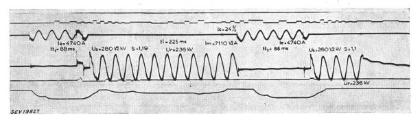
Fig. 7 Oscillogramme d'un essai «décl.-encl.décl.» avec court-circuit entre deux phases du réseau, effectué par le disjoncteur unipolaire décrit
