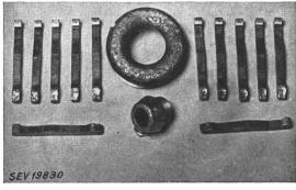
Fig. 10 Contacts à l'état de neuf et après les essais
