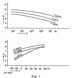
Abhängigkeit der Dielektrizitäts-Konstante  $\epsilon$  von Cellulose-Fasern von der Messfrequenz f und von der Temperatur t Messungen von Stoops
