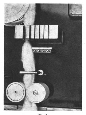
Fig. 3 Aufbau des Messkammes ältere Ausführung
