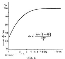
Relative Anzeige  $A/\hat{A}$  in Funktion der Wellenlänge  $\lambda$  (cm) der als sinusförmig angenommenen Querschnittsveränderungen des Prüfgutes mit der Amplitude  $\hat{A}$  bei einer Breite b der Elektroden von 8 mm
