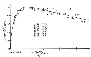
Energieabhängigkeit der Ausbeute für Sekundäremission verschiedener Elemente
