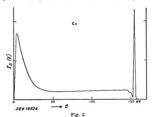
Typisches Energiespektrum von Sekundärelektronen
