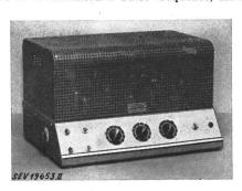
organes de manipulation. Prise pour un microphone. Translateur de sortie avec prises additionnelles pour plusieurs haut-parleurs. Transformateur de réseau à enroulements séparés, pour tension primaire de 220 V. Protection par petit fusible au primaire. Le châssis est muni d'un couvercle en tôle perforée.
