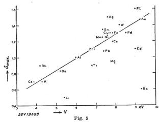
Zusammenhang zwischen maximaler Ausbeute und Ionisationspotential der äusseren Elektronenschale des Atoms
