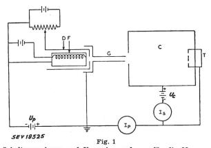
Schaltungsschema und Versuchsanordnung für die Messung der Sekundäremission Erklärungen siehe im Text
