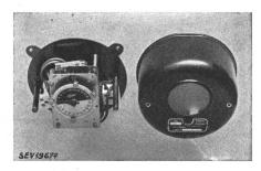
d'un certain nombre de cavaliers pour l'actionnement du déclencheur. Lignes d'amenée de courant au moteur synchrone et au déclencheur, fixées à deux dominos.
